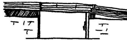
2 b. Paso del 1º tajo. Entibación rígida: Descenso del hastial sin afectar a la galería o deslizamiento de la grapa del lado del tajo y eventual fisuración del techo en el lado opuesto al trabajar en mensula.
